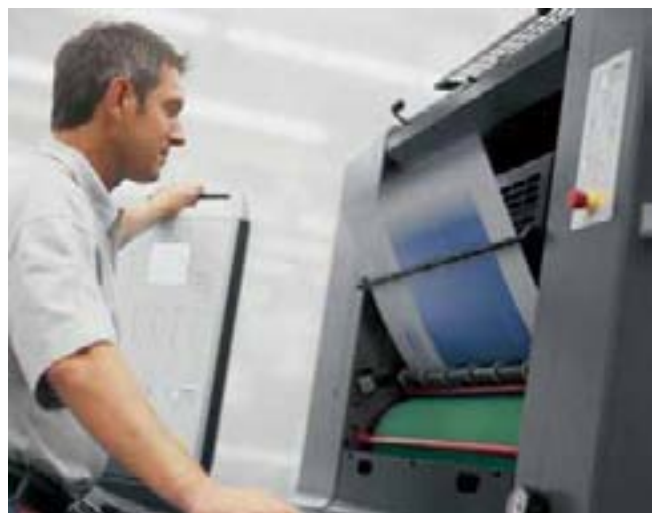
Einfach einlegen und automatisch einziehen lassen: AutoPlate
