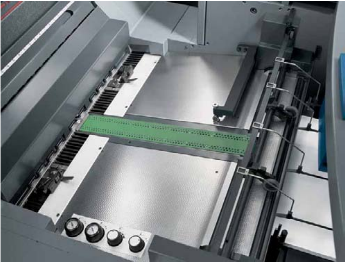
Einfach überzeugend: das zentrale Saugband für optimalen Papiertransport
