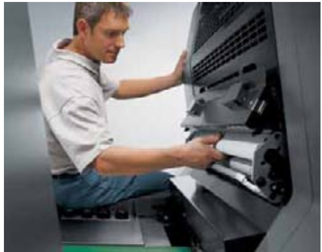
Einfach zugänglich: So leicht wird die Wascheinrichtung gewechselt
