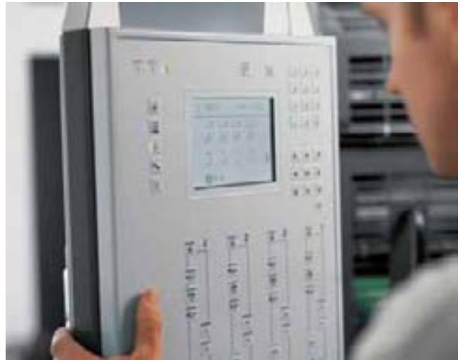
Per Knopfdruck sauber: Die automatische Farbwalzenwascheinrichtung ist einfach bedienbar
