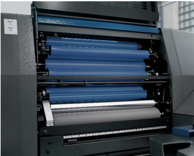
Система непрерывного пленочного увлажнения Alcolor обеспечивает равномерное нанесение тонкой пленки увлажняющего раствора.
